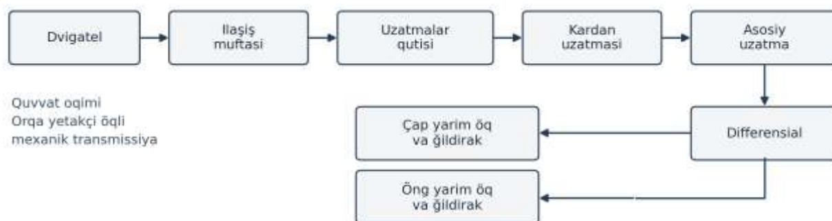
Rasm 1. Mexanik transmissiyada quvvat oqimining funksional sxemasi. [1] asosida tuzilgan; oldingi yetakçi oqli tuziliřda uzun kardan bōlmasligi mumkin.
